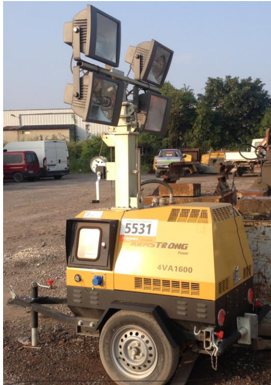
Figure n°10 : Mats d'éclairage mobile
